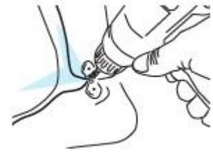
16. PIVOTパンチ（別途購入可能）を使用してプラスチックにヒンジプレート取付穴を正確にあけます。PIVOTパンチがない場合 5mm（もしくは 13/65インチ）のドリルビットを使用します。
