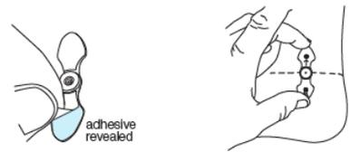
8. 回転軸プレートの中央穴から付属の釘で陽性モデルに固定し継手が動かないようにします。
